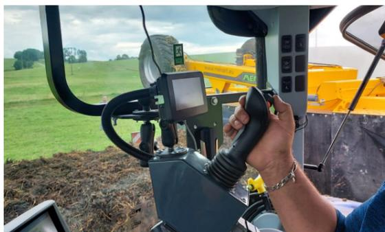
Tutti i movimenti sono controllati dalla cabina tramite un terminale touch e un joystick.
