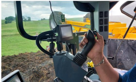
Alle Funktionen werden von der Kabine aus über ein Touchscreen-Terminal und einen Joystick gesteuert.
