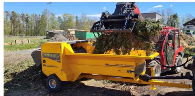
Die MENART-Shreddern sind vielseitig und eignen sich perfekt für kleine und mittlere Baustellen. Hauptverwendungszweck ist das Zerkleinern von Grünabfällen, aber er kann auch Altholz, Paletten, Tiermist und Bioabfälle verarbeiten. Er ist mit verschiedenen Motorisierungen erhältlich (Dieselmotor oder Traktorzapfwelle). Die MENART-Shreddern eignen sich für professionelle Abfallentsorger (Kompostierungsanlagen, Biogasanlagen), Landschaftsgärtner und Baumschulen.
